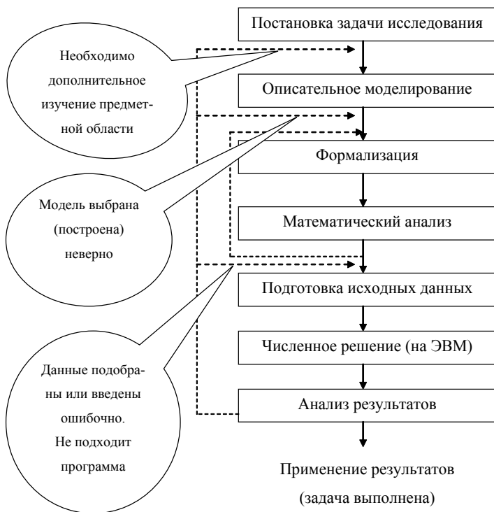
Рис. 4.3. Схема математического моделирования на базе ЭВМ
